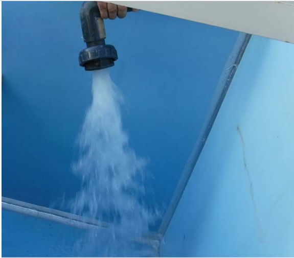
水槽に水を注入しパネルの強度・撓み・漏水状況を検査
