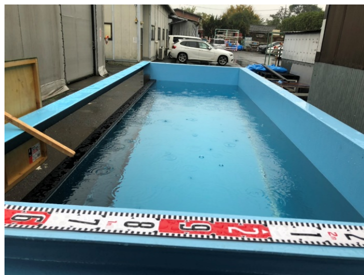
専用プールで 水深1mの水圧テスト
