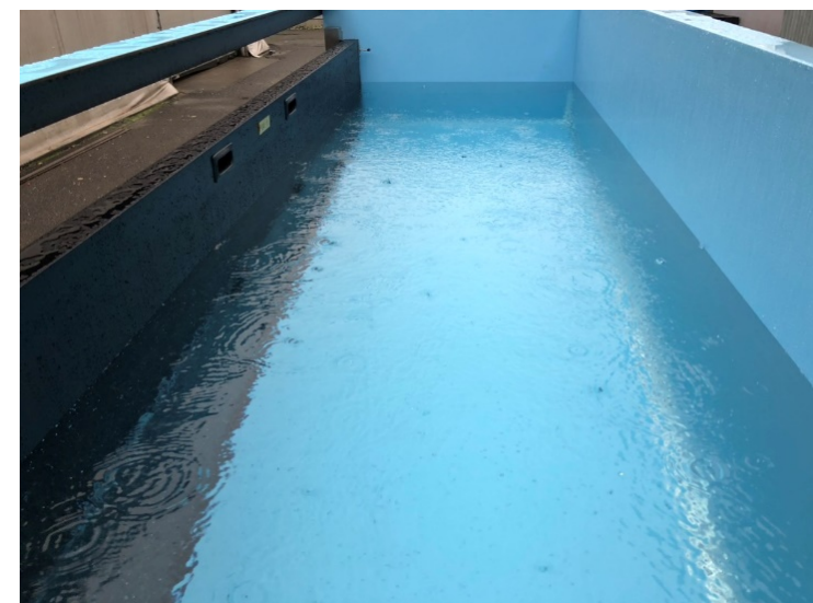
専用プールで 水深1mの水圧テスト
